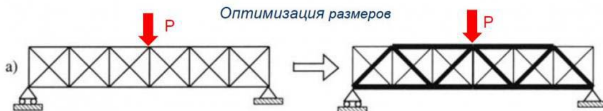
Рисунок 1 – Параметрическая оптимизация конструкции
