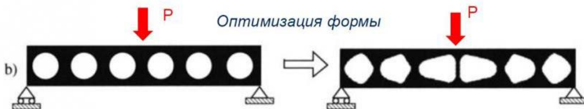
Рисунок 2 – Топологическая оптимизации конструкции
