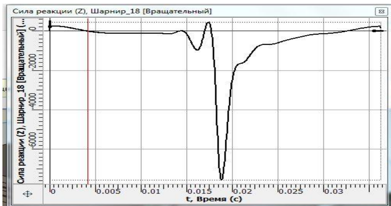
Рисунок 29 – Сила реакции на коленчатый вал
